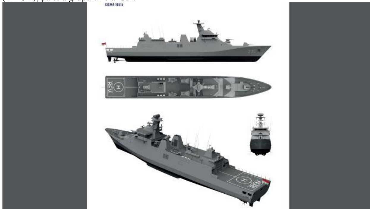
Schema unei nave de tip SIGMA 10514 a Forțelor Navale Indoneziene (Damen)
