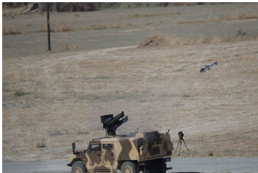
Lansarea unei rachete Akeron MP, de generația a V-a, produsă de MBDA, de pe un blindat 4x4 Sherpa. Foto: Ministerul Apărării din Cipru
