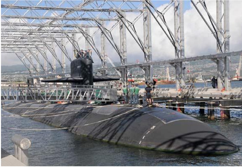
Fig. 2.12. Submarin US Navy, Clasa „Los Angeles”, într-un poligon specializat de demagnetizare.
